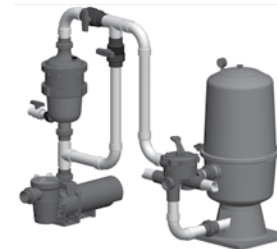
Instalación habitual con un filtro de tierra de diatomeas
